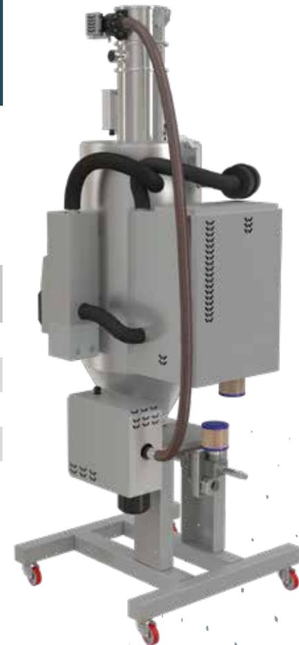
Kit d'alimentation avec turbine de vide externe et filtre contrôlé par la commande du dessiccateur DW
