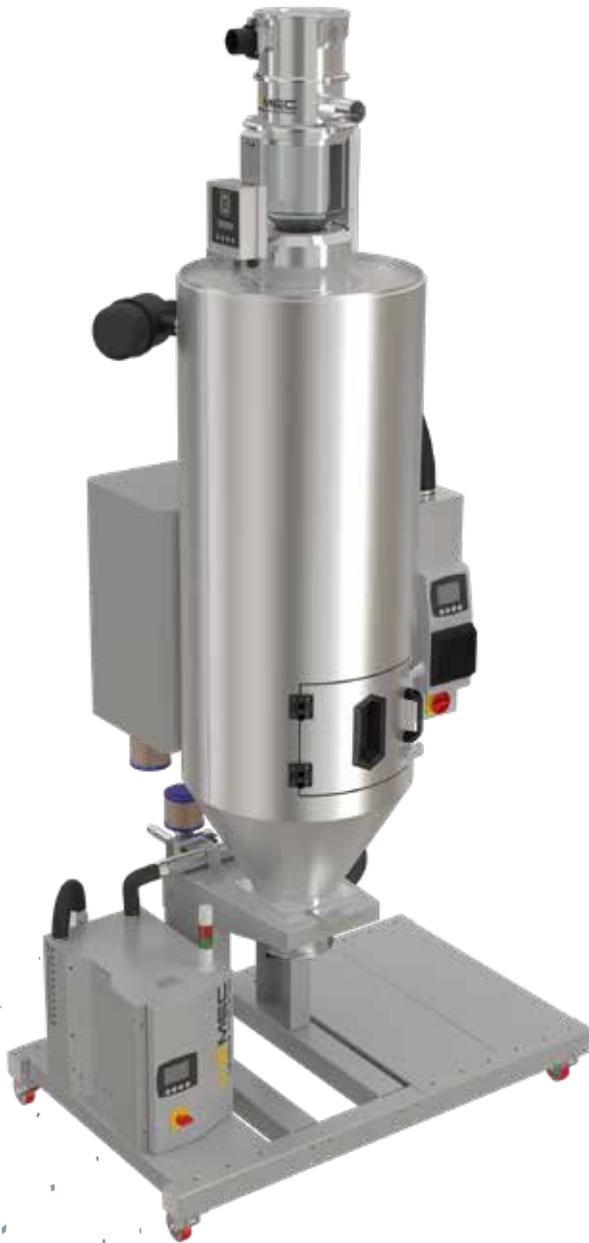
En cas de transport centralisé de matière dessiquée, le Vismec Dryfeed fournit de l'air sec au processus de transport afin d'éviter que la matière ne prenne l'humidité ambiante pendant le transfert. Un système de dessiccation dédié au transport évite également l'utilisation d'air sec provenant d'un processus de séchage des matériaux. Le Vismec Dryfeed system peut également être installé sur un système de convoyage tiers (existant d'une autre marque).
