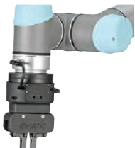
545 KIT-UR-J Pince électrique à parallélogramme avec boîtier condensateur intégré (kit pour robot UR) Parallelogram electric gripper with built-in capacitor box (kit for UR robot)
