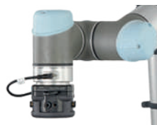
544 KIT-UR-G Pince électrique à 2 mâchoires avec couverture en plastique et boîtier condensateur (kit pour robot UR) 2-jaw electric gripper with plastic cover and capacitor box (kit for UR robot)
