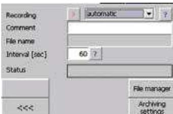
Les données enregistrées sur la clé USB (jusqu'à 80 000 enregistrements au format CSV) peuvent ensuite être exploitées sur ordinateur via NTGraph ou un tableur standard (par ex. MS Excel).
