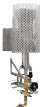
**Torche de brûlage** pour la postcombustion des gaz d'échappement. La torche est énergie gaz et fonctionne au propane. Elle est conseillée pour les processus dans lesquels il n'est pas possible d'utiliser un catalyseur.
