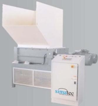
*Les broyeurs peuvent être utilisés soit en pied machine ou pour une production élevée. Ce sont des machines pour le recyclage en direct des carottes et/ou pièces défectueuses lors de la production. Les déchiqueteurs sont utilisés pour les grandes pièces et ils garantissent la meilleure réduction des matières rebroyées pour un meilleur recyclage.*
