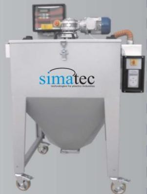
Flexibilité, efficacité et fonctionnalité sont quelques unes des qualités des sécheurs à air chaud EMS - ETS. EMS série embarquée, ETS série sur châssis. La diffusion de l'air chaud à l'intérieur de la trémie de séchage permet un séchage complet pour les matières non hygroscopiques.
