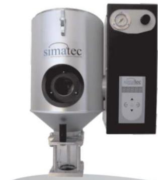
I deumidificatori ad aria compressa sono innovativi per il processo di deumidificazione dei materiali termoplastici igroscopici in granulo. E' la soluzione ideale per il trattamento di basse produzioni direttamente sulla macchina trasformatrice. Il sistema a "tecnologia compressa" utilizza l'aria compressa dosata necessariamente dal circuito tecnologico all'interno della tramoggia per l'asportazione dell'acqua presente nel granulo. Dew Point costante con valore medio -50°C.
