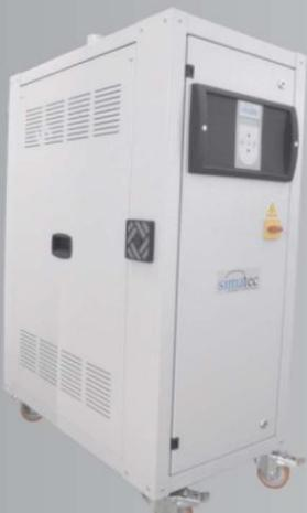
La serie DES rientra nella gamma di deumidificatori più performanti e pertanto ideati e progettati tenendo in considerazione: l'eliminazione dell'umidità dai polimeri igroscopici e il risparmio energetico. Il Dew-Point a seconda del modello di deumidificatore può arrivare fino ad una media di -60°C e pertanto particolarmente adatti anche al trattamento di polimeri tendenzialmente tecnici.
