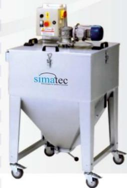
Mescolatori verticali adatti alla mescolazione di qualsiasi tipo di materiale plastico sia in granulo che rimacinato. Ampia gamma di capacità: da 200 a 16.000 litri.
