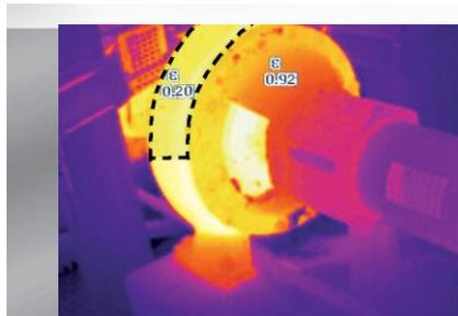
Changement d'émissivité par zone pour une analyse de température plus précise
