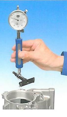
Le caratteristiche principali dei calibri a 2 punti di contatto sono la maneggevolezza, la flessibilità (possono coprire la maggior parte delle esigenze riguardanti la misura dei fori) e l'ampiezza del campo di misura.
