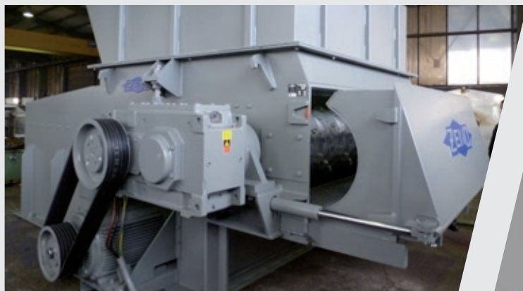
Dispositif hydraulique pour le changement de la grille Permet de sortir les corps étrangers sans problème et un changement rapide de la grille pour changer la taille des broyats.
