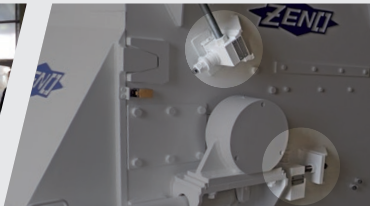
Système de coupe avec 2 contre-couteaux L'équipement de la machine avec deux contre-couteaux permettant un broyage à une petite taille finale des grains sans pré-broyage en une seule étape et augmente le débit.
