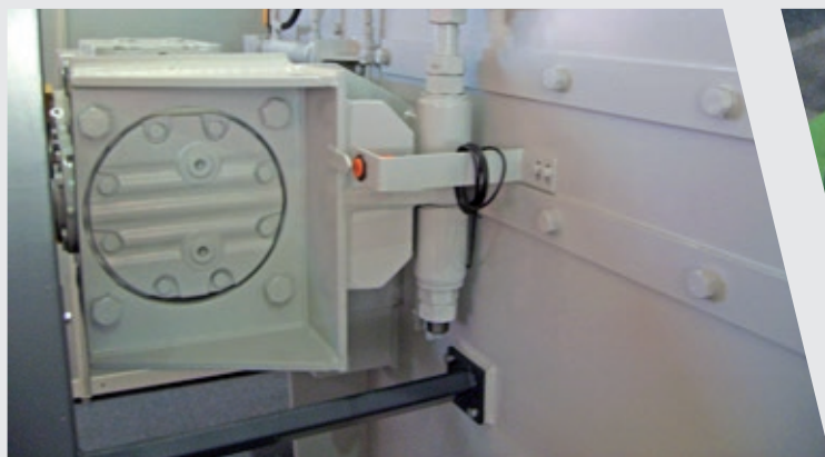
Surveillance inductif du couple Pour protéger la machine contre les dommages causés par des corps étrangers, l'entraînement est surveillé en permanence. Ce dispositif permet l'arrêt de la machine en cas de surcharge.
