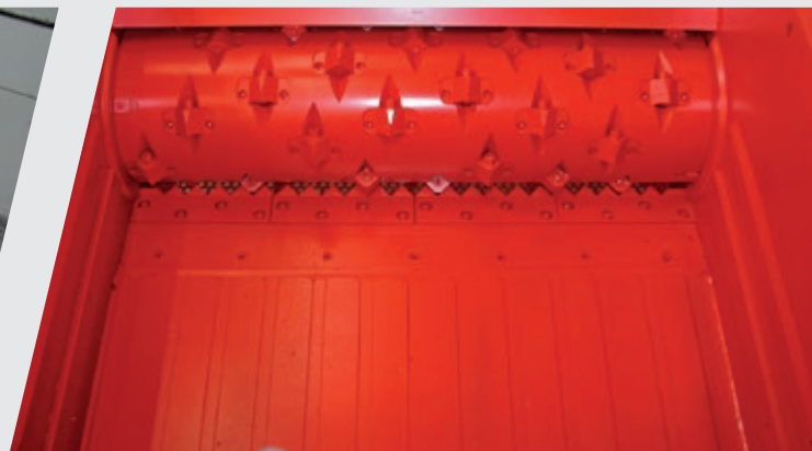
ZTLL avec fond rainuré profilé de sorte qu'aucune matière ne se coince sous le poussoir lors du broyage de matière fine.
