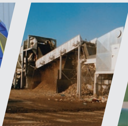
Triage ZENO, par taille des morceaux
