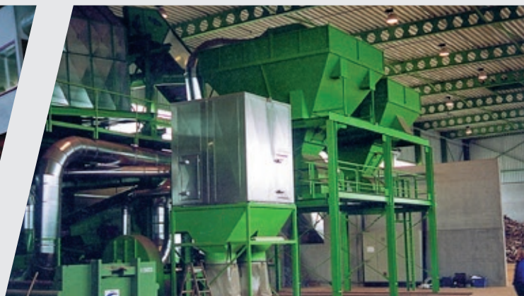
Tri ZENO de décombres lourds avec nettoyage automatique et filtration de l'air
