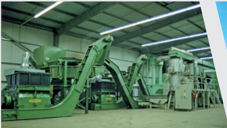
Traitement d'agglomérat ZENO avec des tamis vibrants et de concassage
