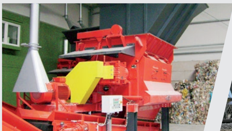
Broyeur ZENO pour le concassage économique de matériaux de toutes sortes
