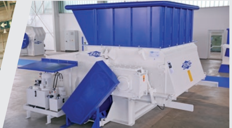
Changement de la taille du broyat grâce à l'attache rapide de la grille
