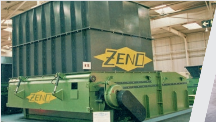
Broyeur ZENO avec 5 mètres de largeur de travail et 60m 3 de volume dans la trémie
