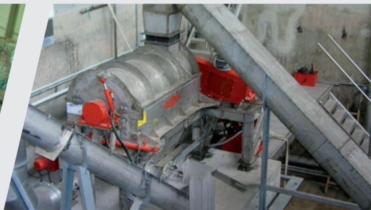
Traitement des déchets alimentaires ZENO, installation en inox
