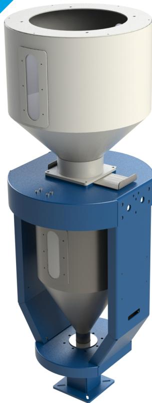
La gamme de systèmes de perte de poids **OPTI-YIELD de TSM** offre une mesure précise, une fiabilité totale et des options de contrôle d'extrusion avancées, permettant d'avoir une qualité du produit optimum, avec une utilisation réduite de matériaux. Le système Opti-Yield fournit une mesure continue du débit et le contrôle automatique du débit.
