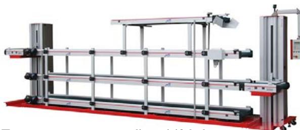
Tampon à étages avec dispositif de levage à deux voies et bande de stockage robotique
