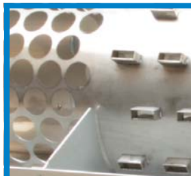
Détails d'une combinaison tambour perforé/tambour de type "hérisson"
