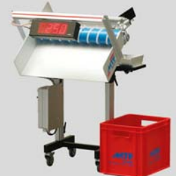
avec séparateur de pièces et compteur
