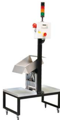
Bascule de distribution avec porte-conteneurs
