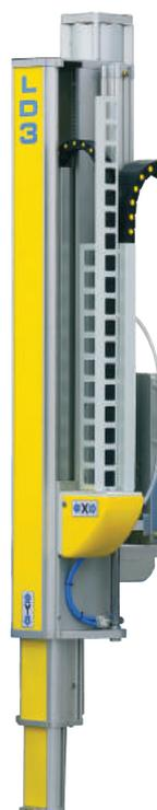
L'axe vertical type T est un télescopique à trois bras avec équilibrage pneumatique, est adressé aux applications qui demandent un encombrement réduit à cause d'un environnement bas ou en présence d'un pont-roulant. Pour prendre les pièces dans le moule, (plateau fixe ou mobile), avec l'axe C pneumatique de 108Nm qui est monté, nous pouvons choisir dans le programme entre deux positions (vertical Y horizontal).
