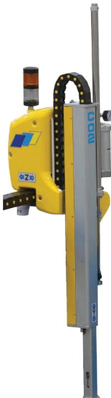
La version X-Series adopte l'axe vertical type S télescopique avec rail de guidage prismatique simple, on obtient une course de travail plus importante, un encombrement vertical mineur, et on peut exploiter les avantages de l'équilibrage pneumatique. Pour prendre les pièces dans le moule, (plateau fixe ou mobile), avec l'axe C pneumatique de 108Nm qui est monté, nous pouvons choisir dans le programme entre deux positions (vertical Y horizontal).
